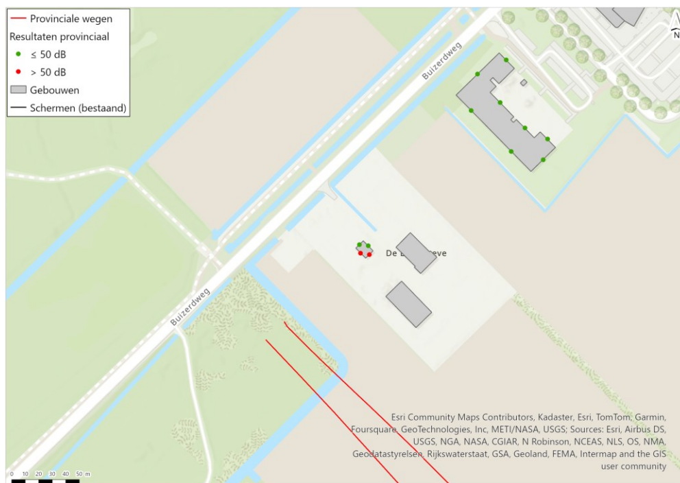
Afbeelding 4.14 Overschrijding standaardwaarde wegen met een geluidproductieplafond
