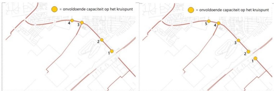
Afbeelding 4.2 Kruispuntenanalyse referentiesituatie 2040 Hoog in de ochtendspits (links) en avondspits (rechts)
