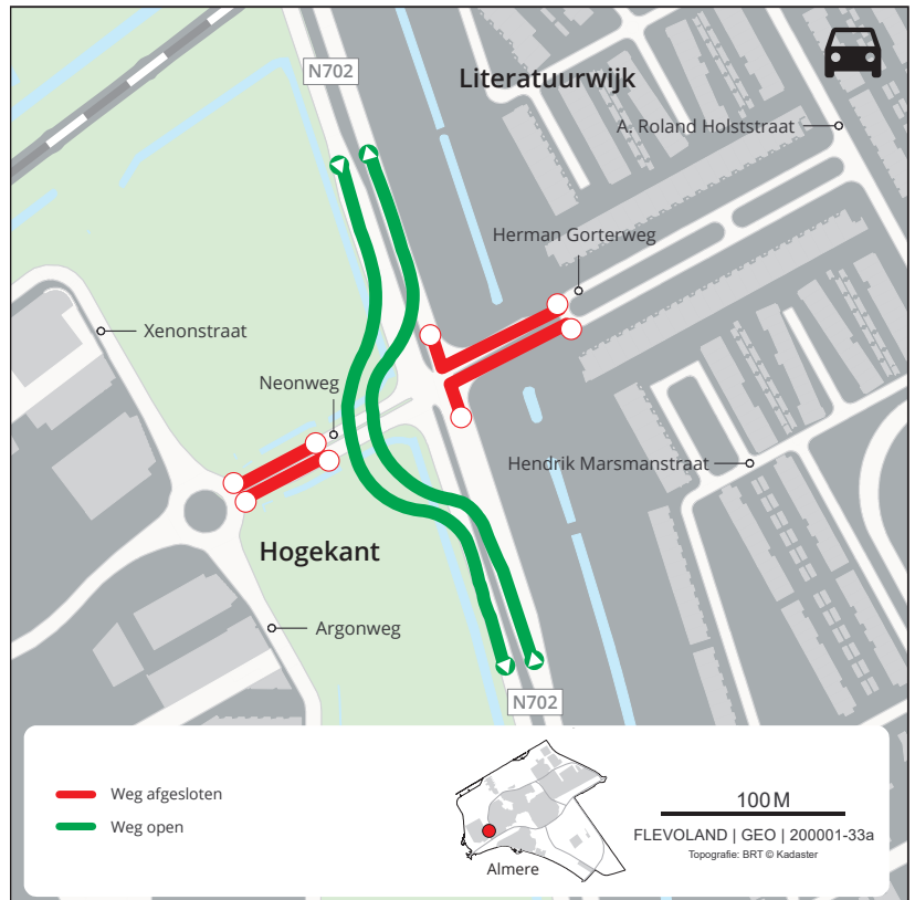
Tijdens de bouw van de tunnelbak rijdt het doorgaande verkeer op de Hogering over een bypass
