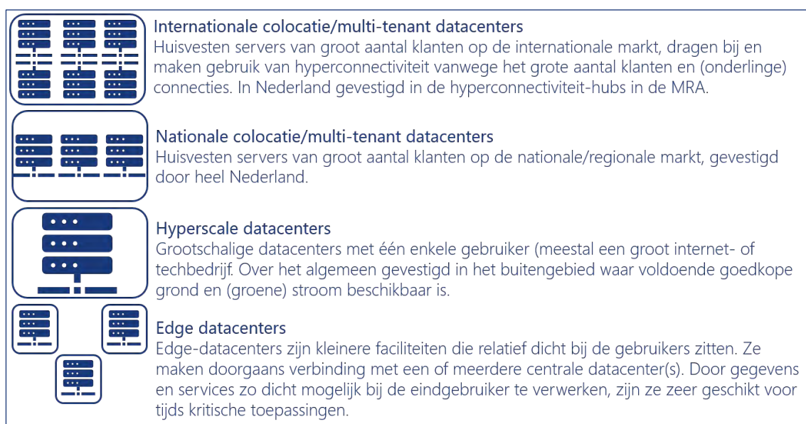
Figuur 1: Typen datacenters in Nederland, waarvan alleen internationale colocatie datacenters gebruik maken van hyperconnectiviteit
