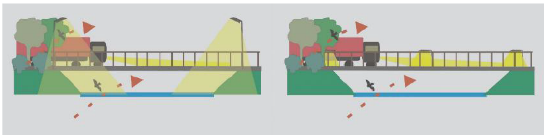
Figuur 6.3 Links: voorbeeld van standaardverlichting op een brug met een niet wenselijke situatie voor vleermuizen. Rechts: verlaagde verlichting op een brug zodat er geen lichtverstoring onder de brug is voor de vleermuizen. Bron: Vleermuizenindestad.nl.
